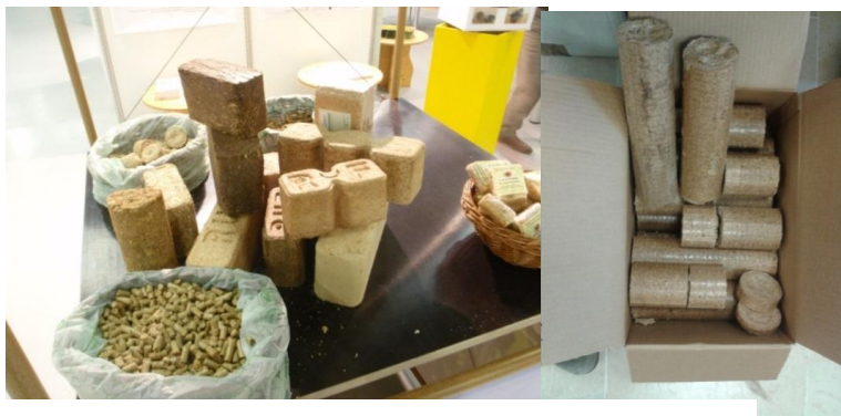
Foto 10: Briquetes de diferents seccions. AFIB-CTFC.
